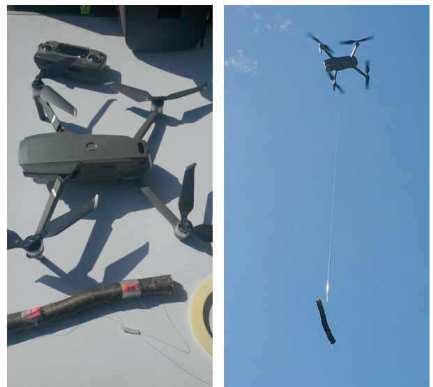
| Un test avec un drone a été réalisé : les balises activées sont fixées à un bâton, attaché au drone par un fin fil de nylon, puis le drone monte à différents paliers d'altitude fixe - © Pierrette Nyssen
